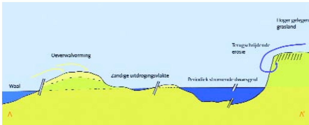
6.11 • Dwarsdoorsnede van geul 2 op de Ewijkse Plaat. Door behoud van een steile oeverwand op de hoek van het niet-afgegraven deel ontstaat mogelijk een aangrijpingspunt voor terugschrijdende erosie (Peters e.a., 2005).
