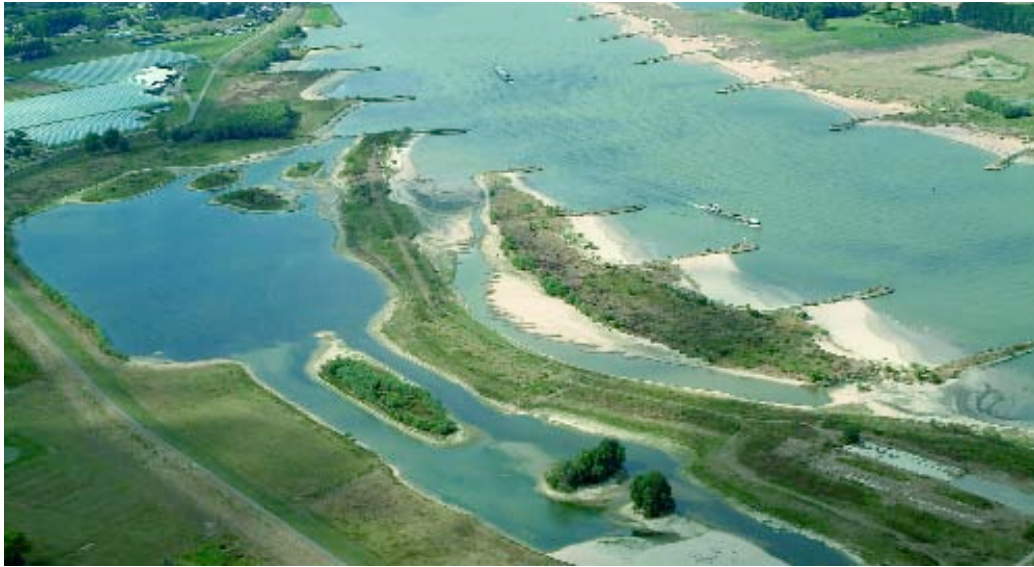
4.5 • De nevengeulen van de Gamberensche Waard. In de grote geul is een zandput opgenomen. Plaatselijk zijn al interessante aanzandingen zichtbaar (foto Rijkswaterstaat).
