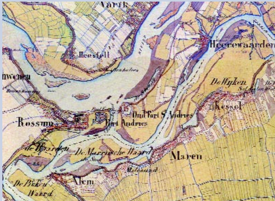
2.12 • Het karakter van de Middenwaal en de Benedenmaas rond Heerewaarden rond 1853. De Waal stond nog in verbinding met de Maas en er waren nog veel eilanden, zandige aanwassen en actieve beddingprocessen. De Middenwaal bovenstrooms van Heerewaarden had een relatief rechte hoofdstroom die echter vol eilanden en zandplaten lag (zoals hier de Varikse Plaats). Plaatselijk lagen stromende nevengeulen of (deels) afgesneden
